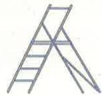
（※）足元の高さが2m以上の箇所で作業する場合には、原則として十分な広さと強度をもった作業床や墜落防止措置（手すり等）を備えた用具を使用してください。特に、はしごは原則昇降のみに使用してください。
